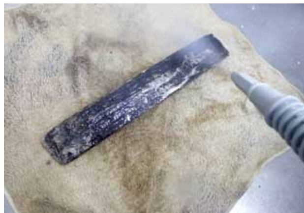
スチームクリーナーによる表面処理状況
