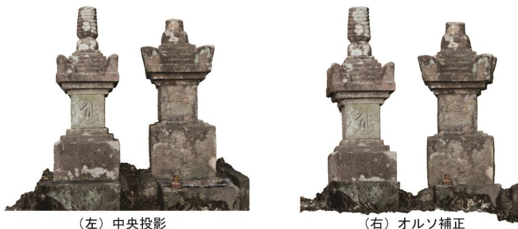
図7 宝篋印塔で比較した中央投影とオルソ画像の違い
