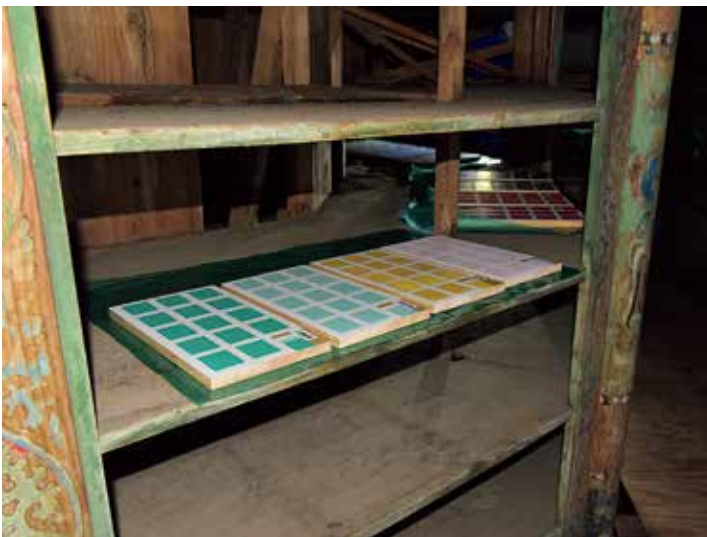
彩色と同じ環境下（輪蔵棚上）での防カビ剤試験状況
