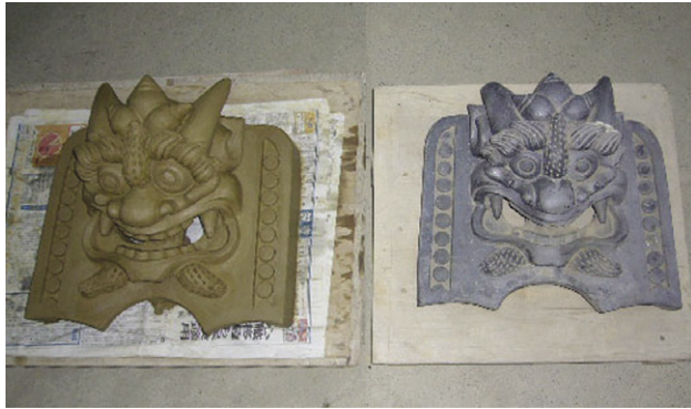
鬼瓦の製作（左が生型、右が本堂隅棟の当初鬼瓦・室町時代）
