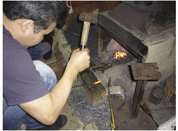
和釘を手打ちで製作している様子
