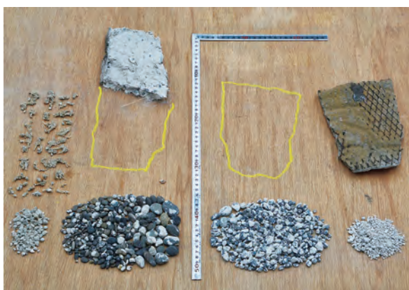
写真10. 外壁の玉砂利漆喰塗りの構成比較
