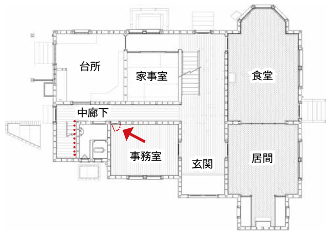
図2. 大正4年時の主屋1階平面図（下側が西面） 事務室に中廊下へ抜ける通用口が存在すること（矢印部分）に『住家』との違いがみられます。
