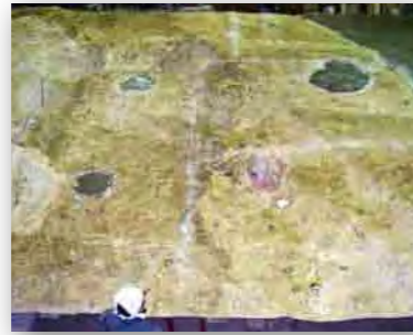
11 脱型 全体を裏返して、現場で制作した木製型枠付の FRP 型を取り外す。
